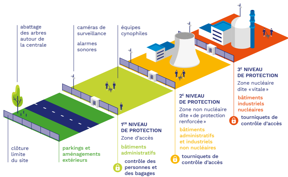
Figure 42. Dispositif de contrôle d'une centrale nucléaire
