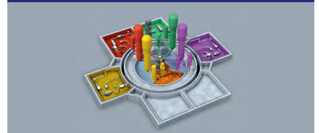
Figure 13. Le dispositif de "stabilisation du corium" sous la cuve du réacteur
