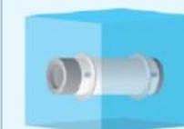
Immersion à 15 m : pour les colis de type B contenant plus de 100 000 A<sub>2</sub> : immersion jusqu'à 200 m. Critère : pas de rupture de l'enceinte de confinement
