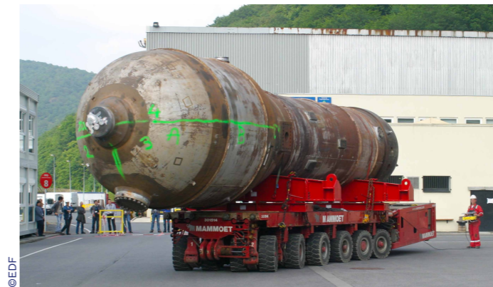
Handling eines abgenutzten Dampferzeugers am EDF-Standort Chooz (Ardennen)
