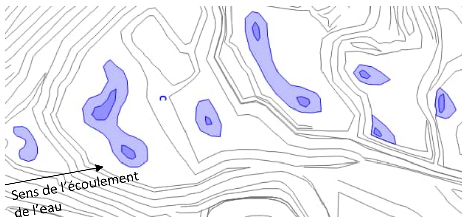
Schéma présentant le réseau de mares pionnières prévu dans la cadre du réaménagement de la carrière de Kaolin.
