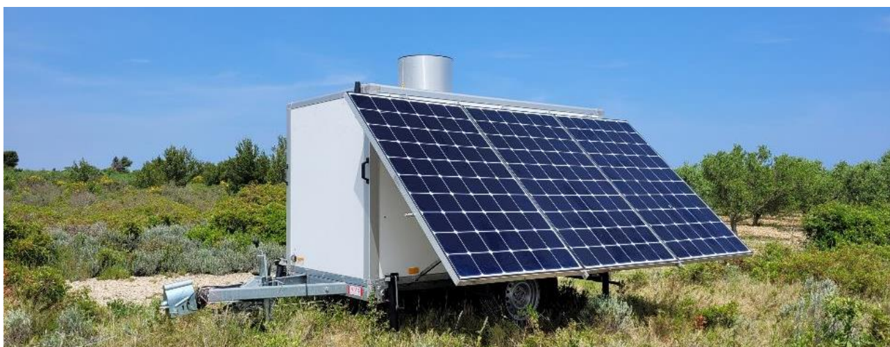
Figure 3 : Dispositifs déployés pour les suivis par radar ornithologique à la côte. En haut, radar fixe, en bas, unité radar mobile.
