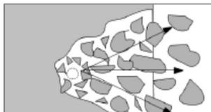
phase4 (t= 0.25 milliseconde): les fissurations radiales et réfléchies se cumulent et les éléments fragmentés du bloc sont projetés
