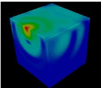
exemple de modélisation de la propagation de l'énergie d'une onde de choc depuis un point d'impact situé sur une arête d'un bloc :
