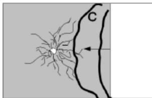
phase3 (t=0.15 milliseconde): l'onde de choc se réfléchit sur la surface libre et sollicite le béton en traction créant une fissuration depuis la surface libre (résistance en traction du béton 10 à 20 fois inférieure à sa résistance en compression)
