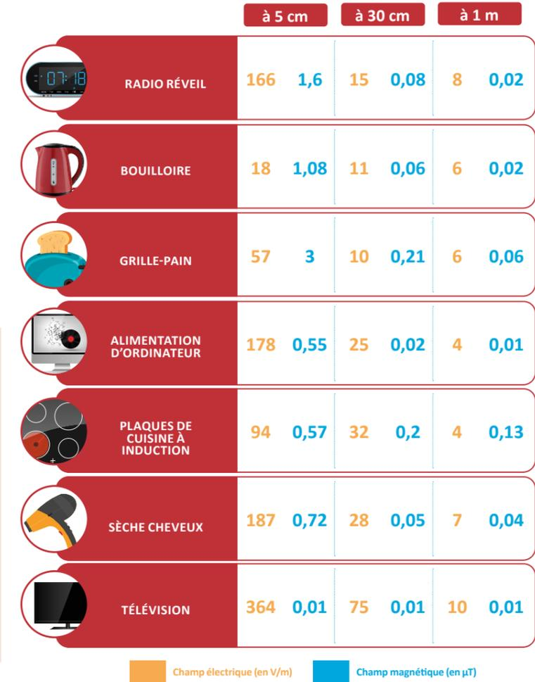
Figure 30 : valeurs des champs électriques et magnétiques à proximité d'appareils électriques à 50 Hz<sup>21</sup>
