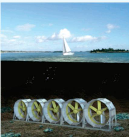
La société Hydrohelix a développé, à partir d'un brevet de turbine dédiée au captage de l'énergie hydrocinétique des courants marins, une technologie spécifique basée sur un concept original d'écran de turbines posées sur le fond marin.
