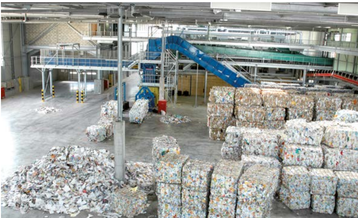
Atelier de mise en balles du centre de tri de collectes sélectives multimatériaux situé à Nanterre
