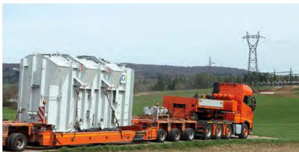
Les transformateurs sont acheminés sur site (transport combiné fluvial et routier)
